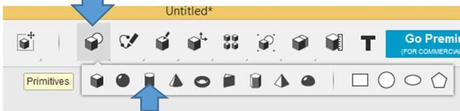
Zylinder auswählen, mit der Maus auf die Arbeitsebene gehen, damit der Zylinder dort erscheint. Radius (11.625mm) und Höhe (2.33mm) in die Eingabefenster eingeben und dann den Zylinder auf der Arbeitsfläche mit einem Linksklick platzieren.
