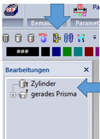
9a. Also: MENÜ KONSTRUKTION – Volumen 3D – Regelkörper - Tonne.
