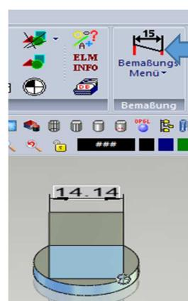
Dazu wähle: MENÜ – KONSTRUKTION – Bemaßungsmenü (Symbol). Klicke auf eine Quaderkante, ziehe die Maßangabe ein wenig vom Quader weg und setze sie mit einem weiteren Linksklick ab. Die Tonne hat also einen Radius von 7,07 mm
