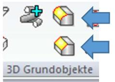
MENÜ KONSTRUKTION – Volumen 3D – Runden/Fasen
